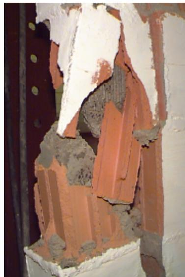
Figura 4.17 - Detalhe da ruptura do graute: Formação do tronco de cone
