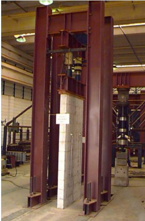
Figura 3.3 – Estrutura de ensaio dos painéis de parede
