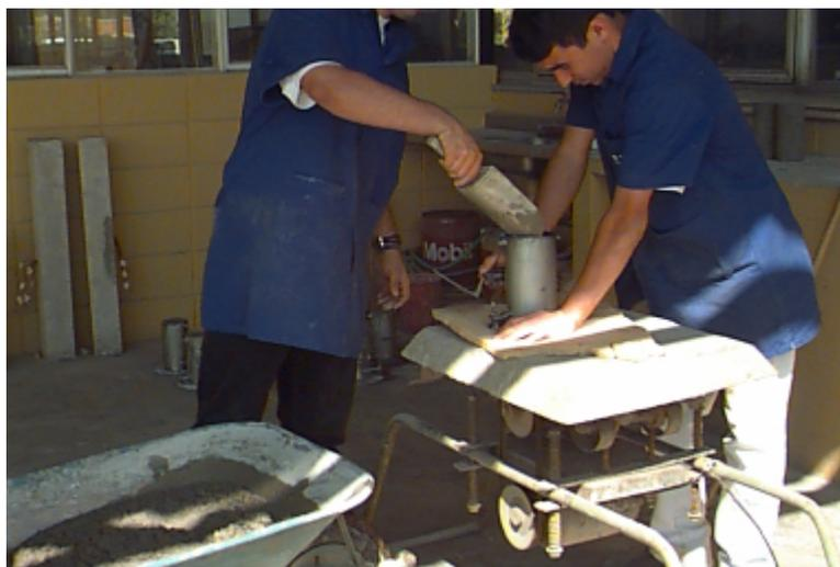
Figura 4.6- Adensamento de corpos-de-prova em mesa vibratória
