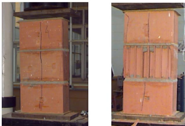
Figura 4.12 – Faces opostas de um mesmo prisma após a ruptura
