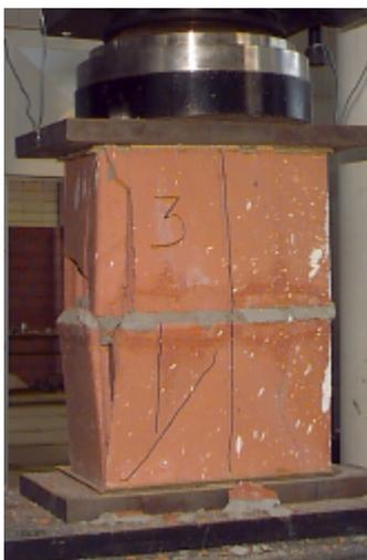
Figura 4.13 – Ruptura de prisma de 2 blocos
