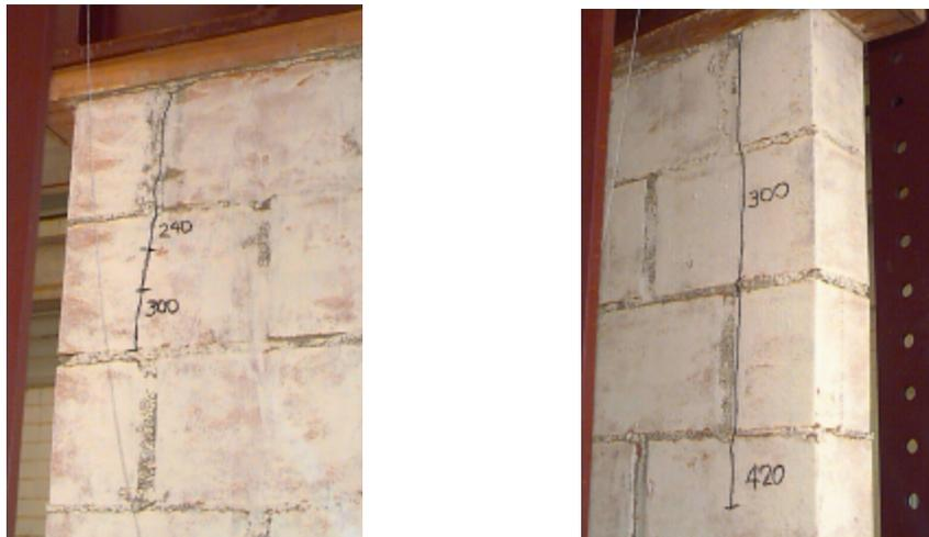
Figura 3.5 – Fissuração da parede 10
