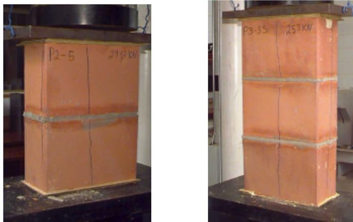
Figura 3.4 – Ruptura de prismas de 2 e 3 blocos
