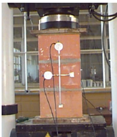
Figura 4.7 – Instrumentação do prisma de três blocos
