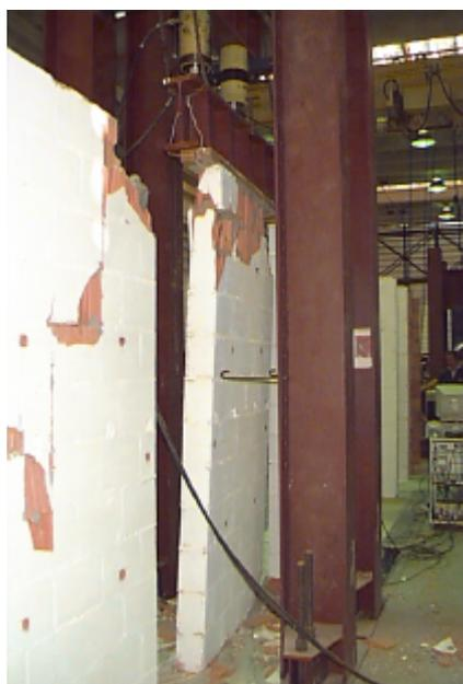
Figura 4.14 – Ruptura da parede 3
