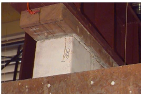
Figura 6.3 – 1ª fissura de uma parede sem graute
