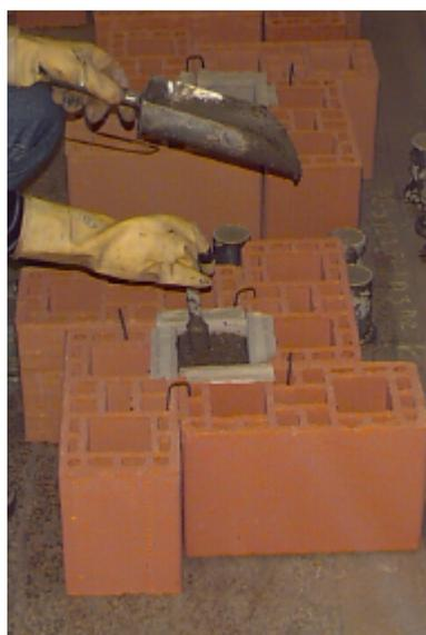
Figura 4.4 - Execução de corpos-de-prova com fôrma de blocos
