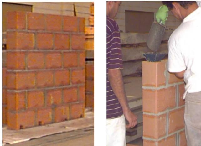
Figura 4.8 - Execução da 1ª etapa da parede (1,20 m)
