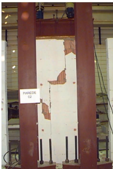
Figura 4.16– Ruptura da Parede 2
