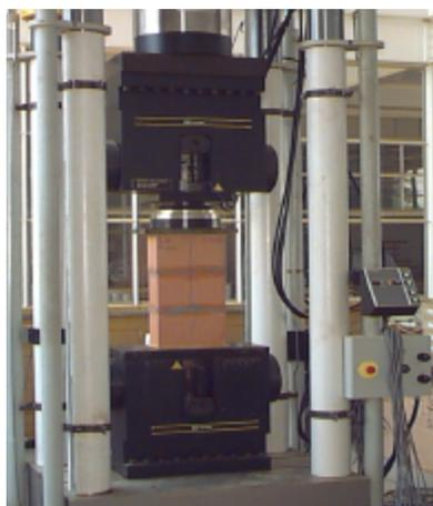
Figura 3.2 – Ensaio de prismas de 3 blocos
