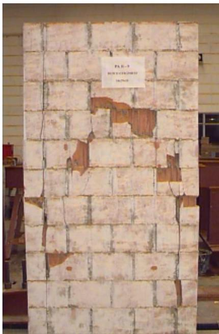
Figura 3.6 - Ruptura da parede
