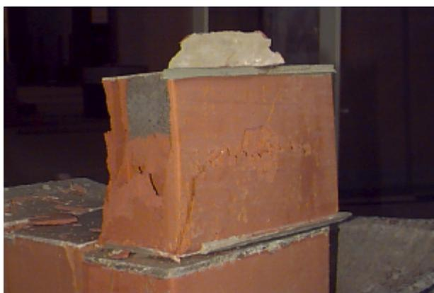
Figura 4.11 – Bloco ensaiado à compressão simples
