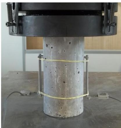
Figura 3.30 – Instrumentação do corpo de prova de graute no ensaio de resistência à compressão
