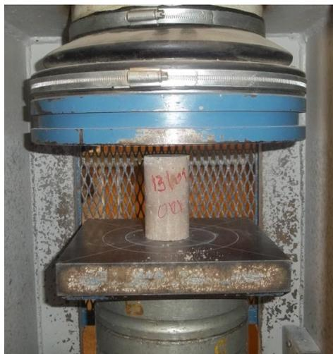
Figura 3.27 – Ensaio à compressão da argamassa
