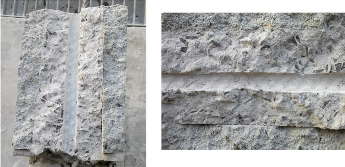
Figura 6.26 – Detalhe das interfaces nos corpos de prova de blocos de concreto
