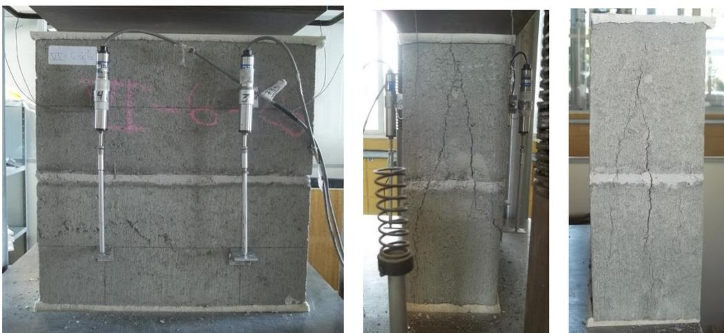
Figura 4.23 – Modo de ruptura dos prismas de concreto de dois blocos da série CoG30 (graute G30)
