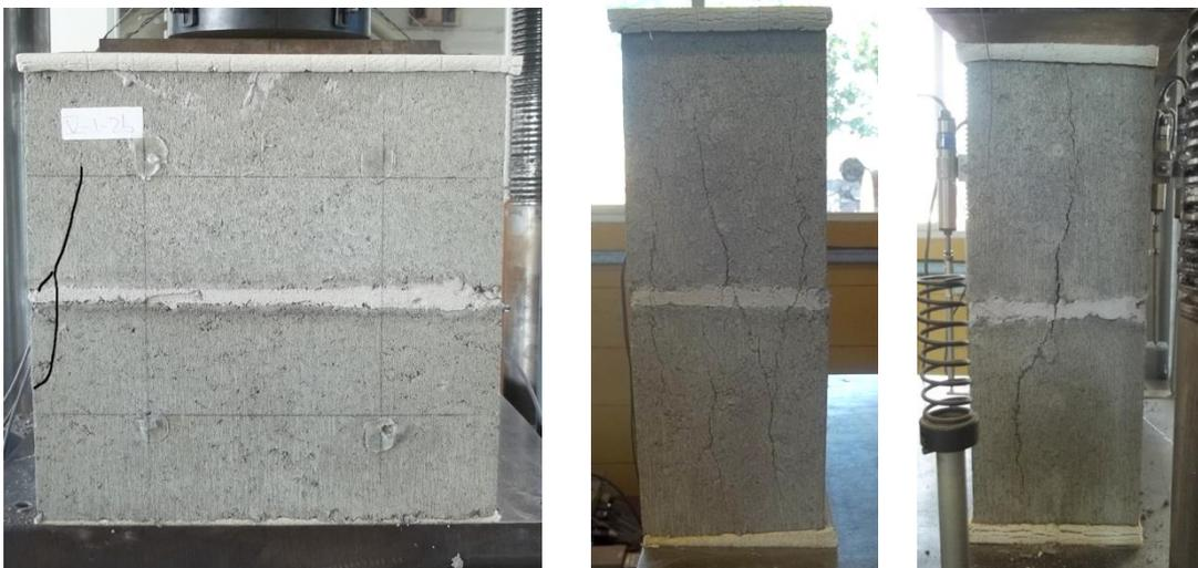
Figura 4.22 – Modo de ruptura dos prismas de concreto de dois blocos da série CoG14 (graute G14)
