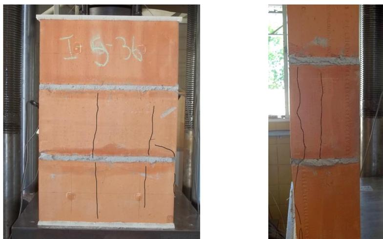
Figura 4.8 – Modo de ruptura dos prismas cerâmicos de três blocos da série Ce (não grauteados)
