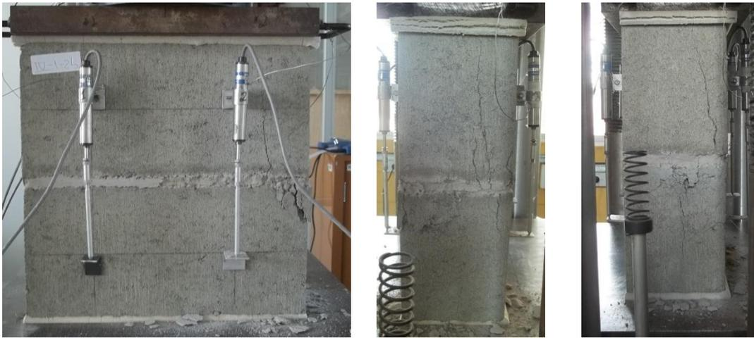
Figura 4.21 – Modo de ruptura dos prismas de concreto de dois blocos da série Co (não grauteados)
