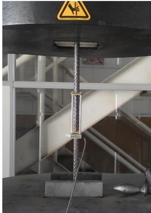
Figura 5.16 – Ensaio de resistência à tração da barra de aço
