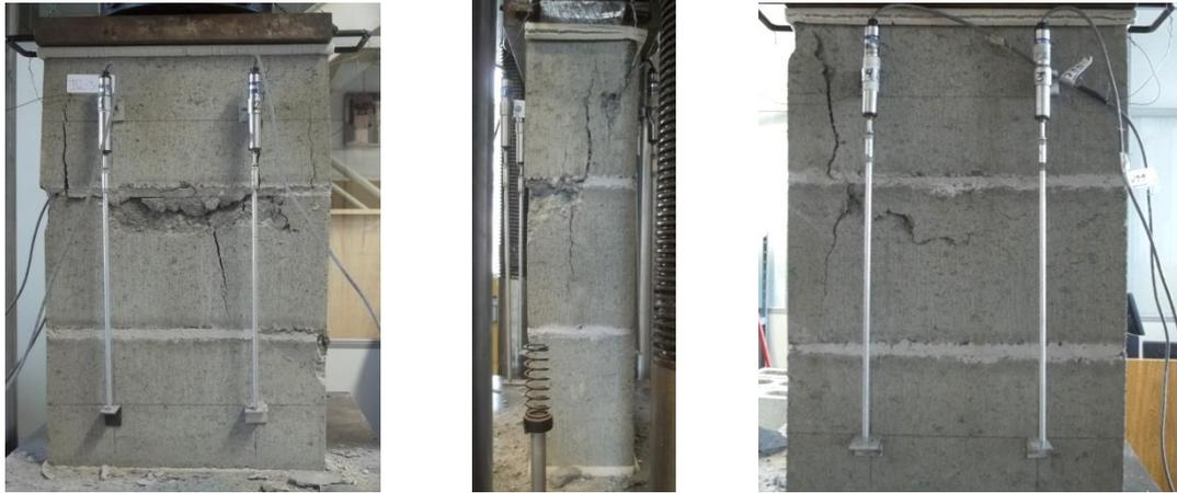
Figura 4.27 – Modo de ruptura dos prismas de concreto de três blocos da série Co (não grauteados)
