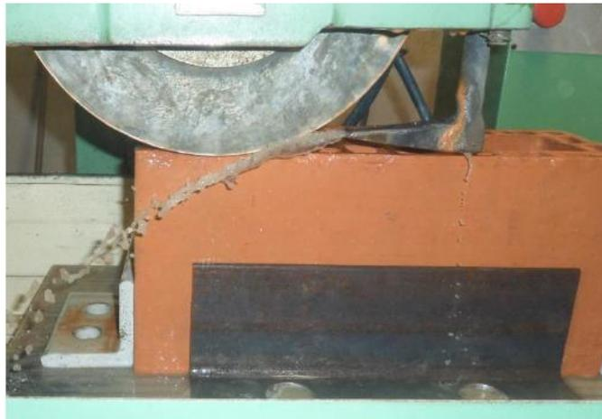
Figura 3.7 – Regularização da superfície do bloco cerâmico através de uma retífica
