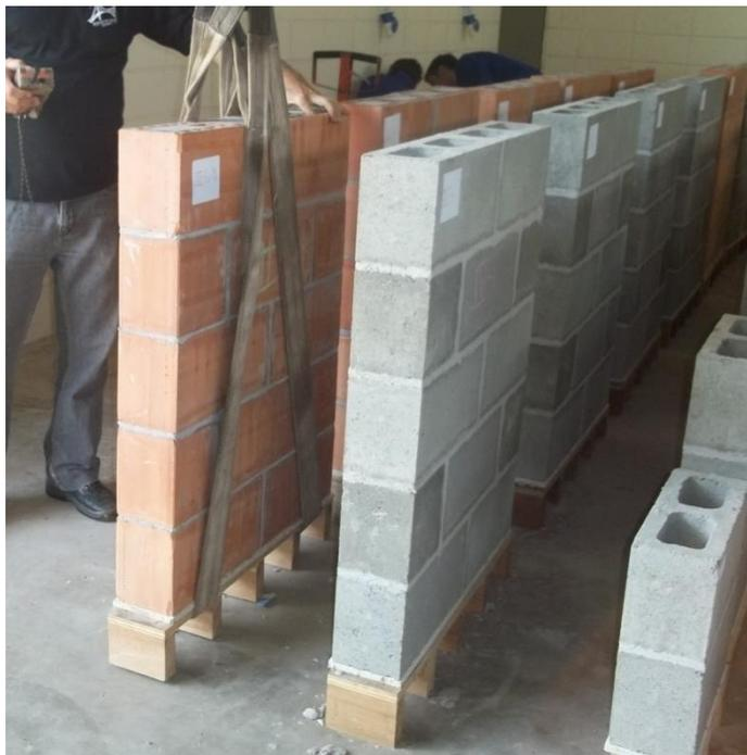
Figura 3.40 – Armazenamento e transporte dos corpos de provas
