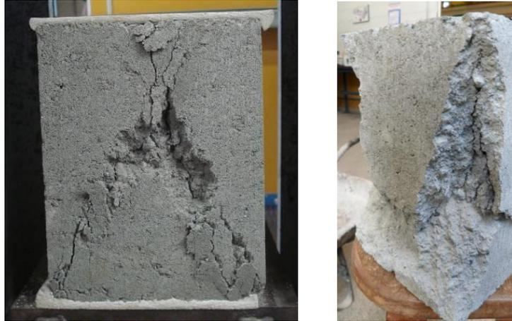
Figura 3.14 – Ruptura típica do bloco de concreto submetido ao ensaio de resistência à compressão
