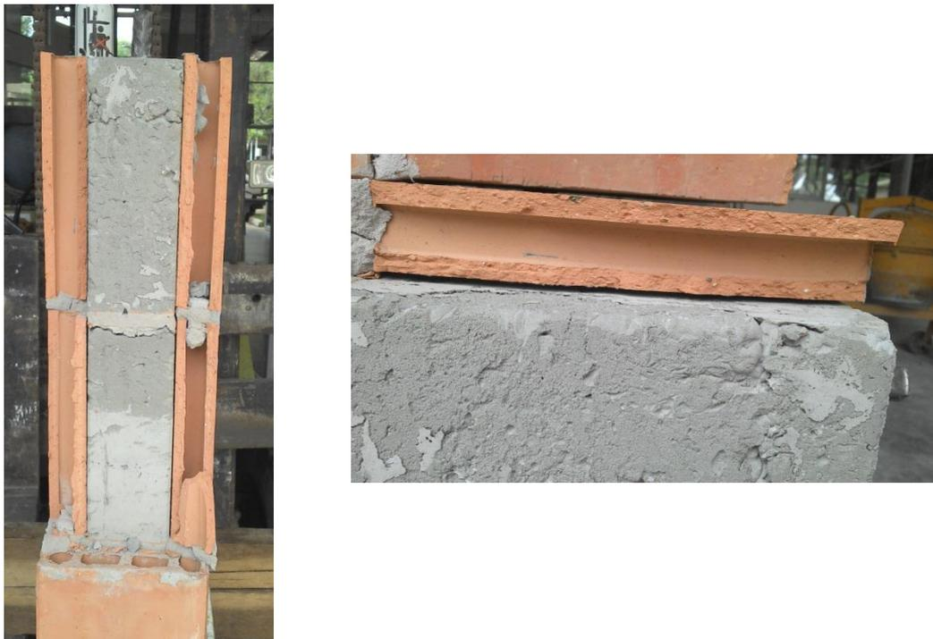
Figura 6.27 – Detalhe da interface graute/bloco nos corpos de prova de blocos cerâmicos
