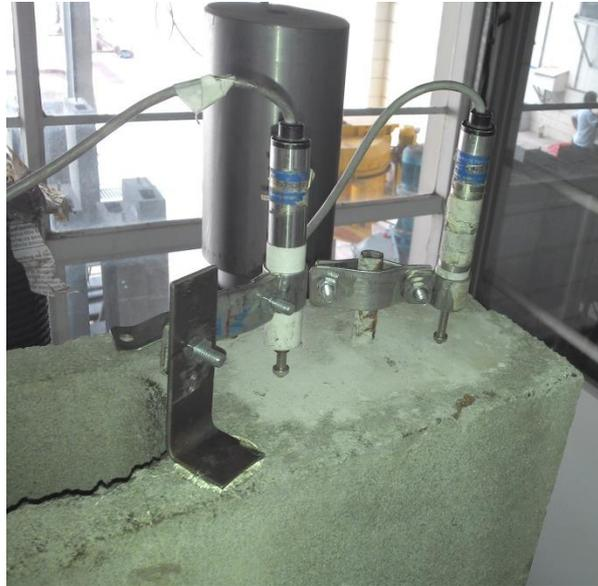
Figura 5.15 – Instrumentação utilizada nos ensaios de “pull-out”
