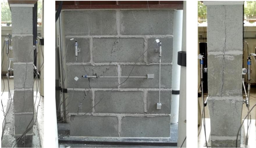
Figura 4.35 – Modo de ruptura das pequenas paredes de concreto da série CoG14 (graute G14)
