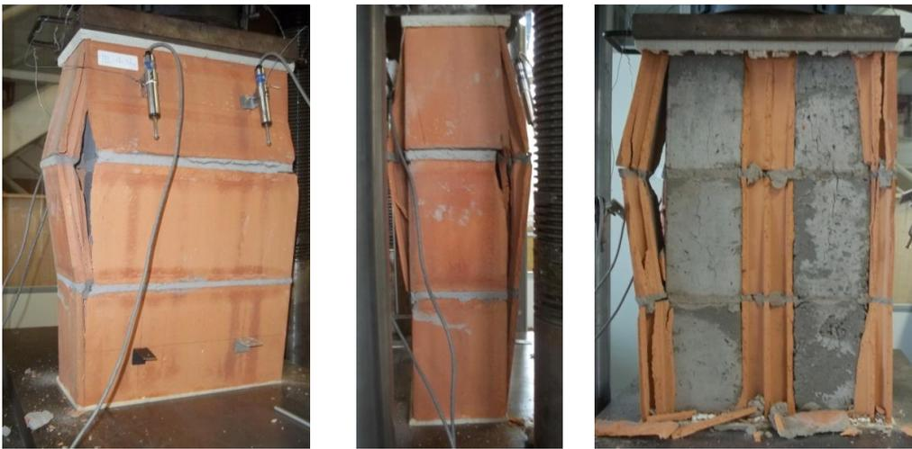
Figura 4.10 – Modo de ruptura dos prismas cerâmicos de três blocos da série CeG30 (graute G30)
