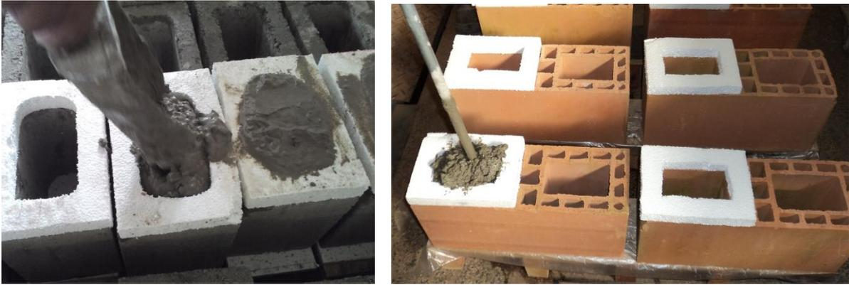
Figura 5.4 – Grauteamento dos corpos de prova para o ensaio de “push-out”
