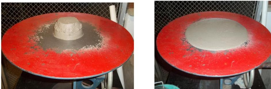
Figura 3.25 – Ensaio da consistência da argamassa
