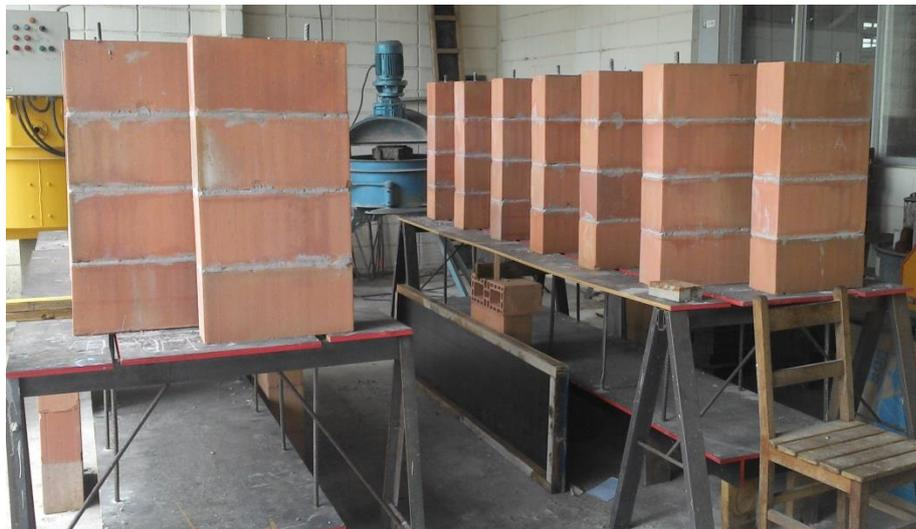
Figura 5.6 – Posicionamento dos corpos de provas de “pull-out”
