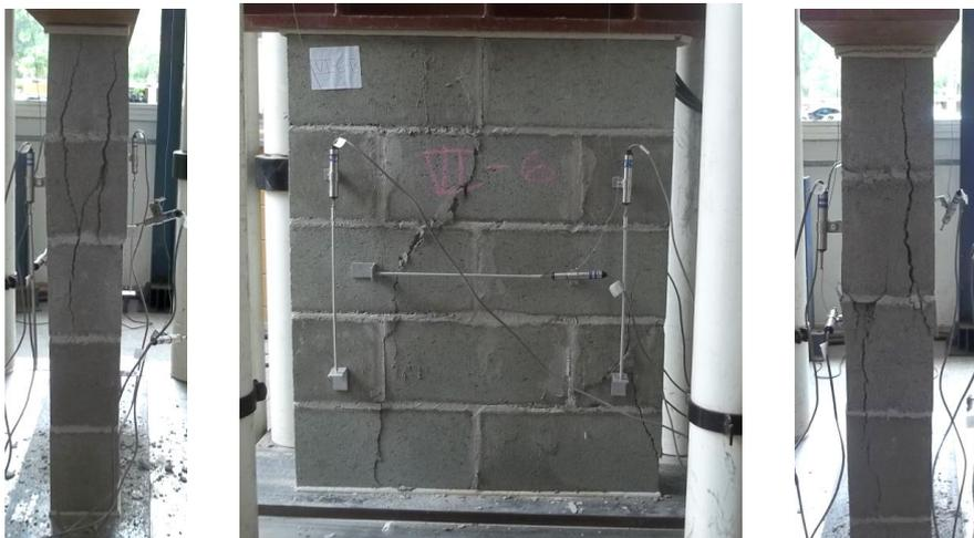
Figura 4.36 – Modo de ruptura das pequenas paredes de concreto da série CoG30 (graute G30)
