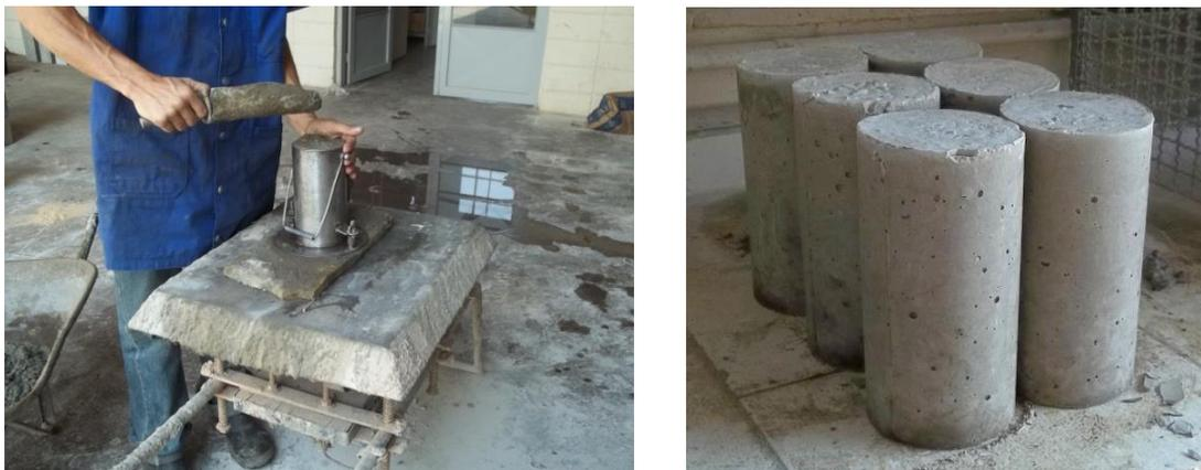
Figura 3.29 – Adensamento e desmoldagem dos corpos de prova do graute
