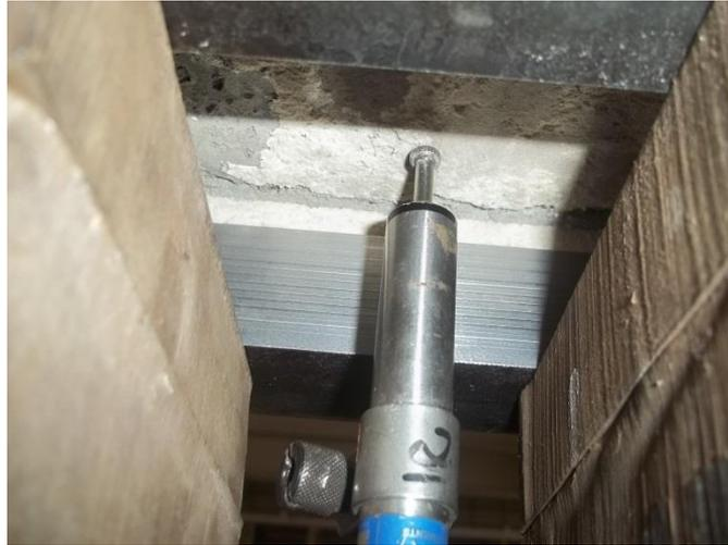
Figura 5.13 – Transdutor colocado na parte inferior do graute para a medição dos deslocamentos
