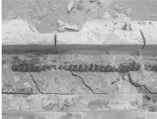
Figura 2.25 – Modo de ruptura no interior dos corpos de prova com não contato das emendas (AHMED e FELDMAN, 2012)
