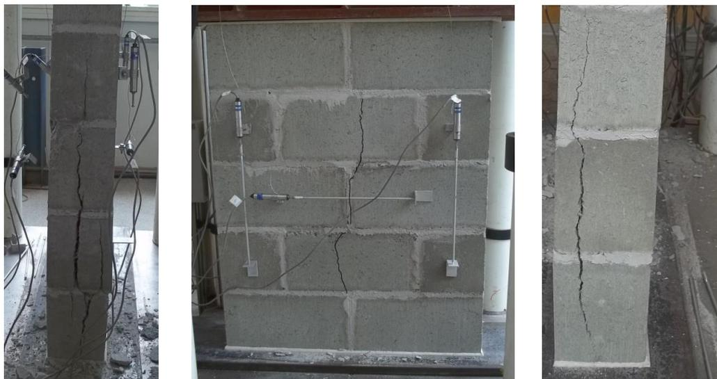
Figura 4.34 – Modo de ruptura das pequenas paredes de concreto da série Co (não grauteadas)
