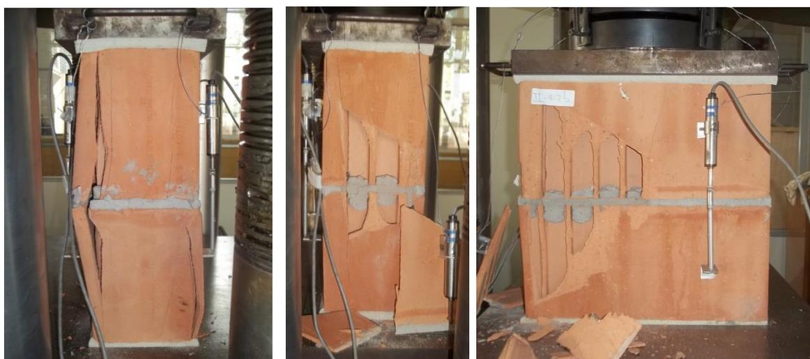
Figura 4.3 – Modo de ruptura dos prismas cerâmicos de dois blocos da série CeG14 (graute G14)
