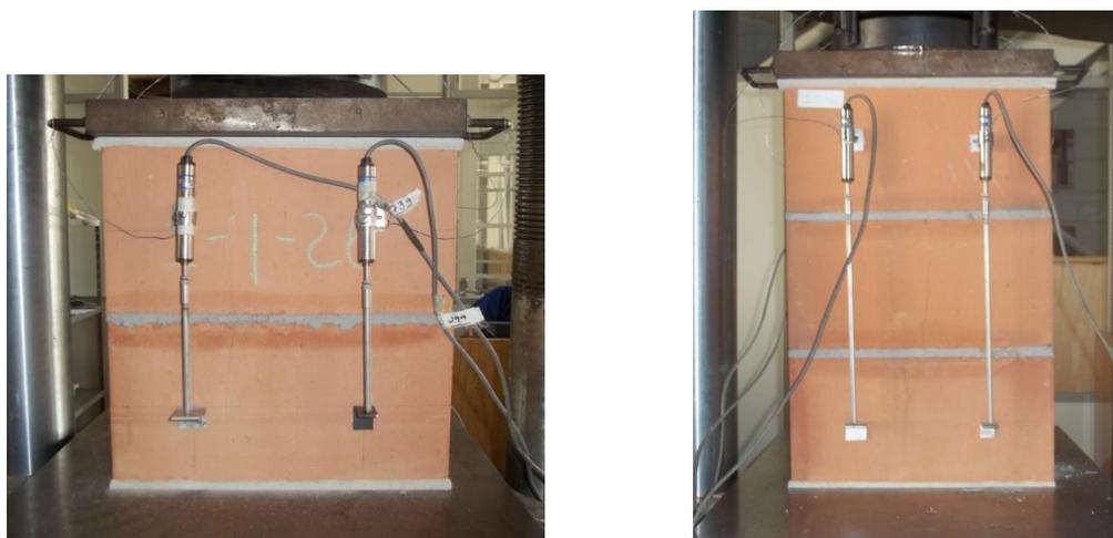
Figura 3.47 – Esquema de ensaio da resistência à compressão dos prismas de blocos cerâmicos
