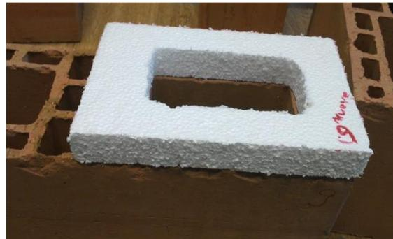
Figura 5.3 – Execução dos corpos de prova de blocos cerâmicos e de concreto para o ensaio de “push-out”
