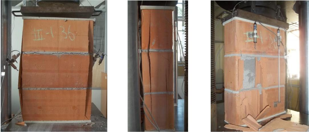
Figura 4.9 – Modo de ruptura dos prismas cerâmicos de três blocos da série CeG14 (graute G14)
