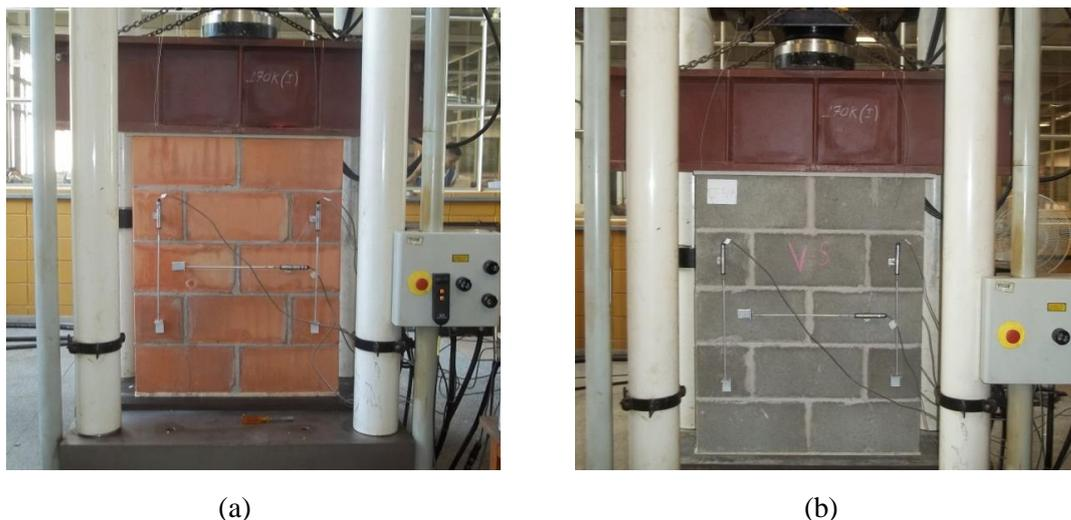
Figura 3.50 – Esquema de ensaio da resistência à compressão das pequenas paredes cerâmicas (a) e de concreto (b)
