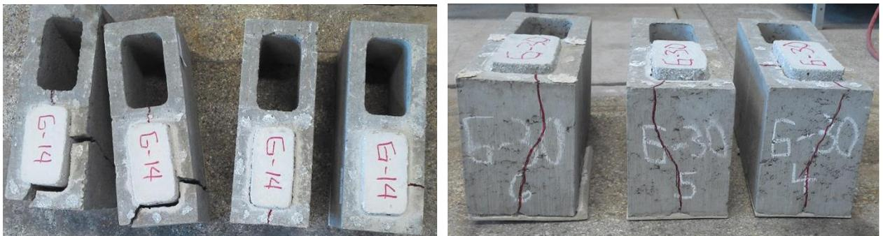
Figura 6.7 – Ruptura típica do ensaio de “push-out” para os blocos de concreto (Co26)
