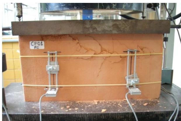
Figura 3.13 – Ruptura típica do bloco cerâmico submetido ao ensaio de resistência à compressão
