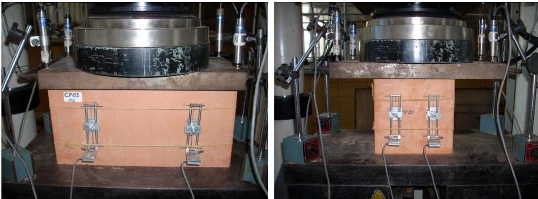
Figura 3.6 – Instrumentação utilizada no bloco inteiro e no meio bloco cerâmico
