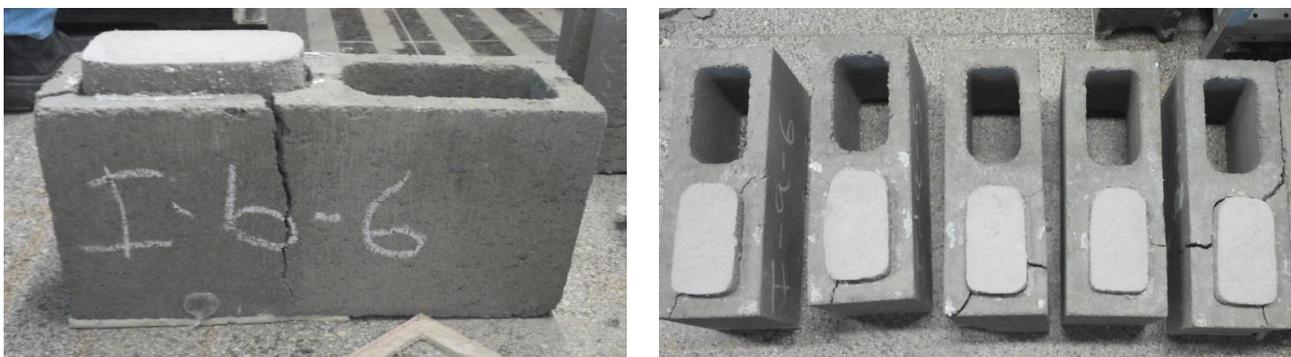
Figura 6.6 – Ruptura típica do ensaio de “push-out” para os blocos de concreto (Co10)
