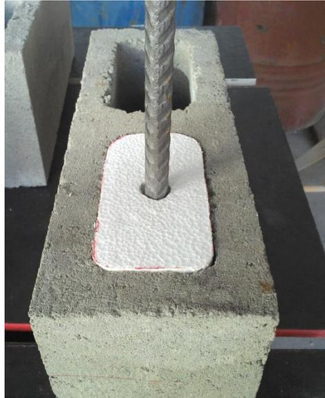
Figura 5.7 – Peça de isopor para evitar o grauteamento do primeiro bloco nos prismas de concreto
