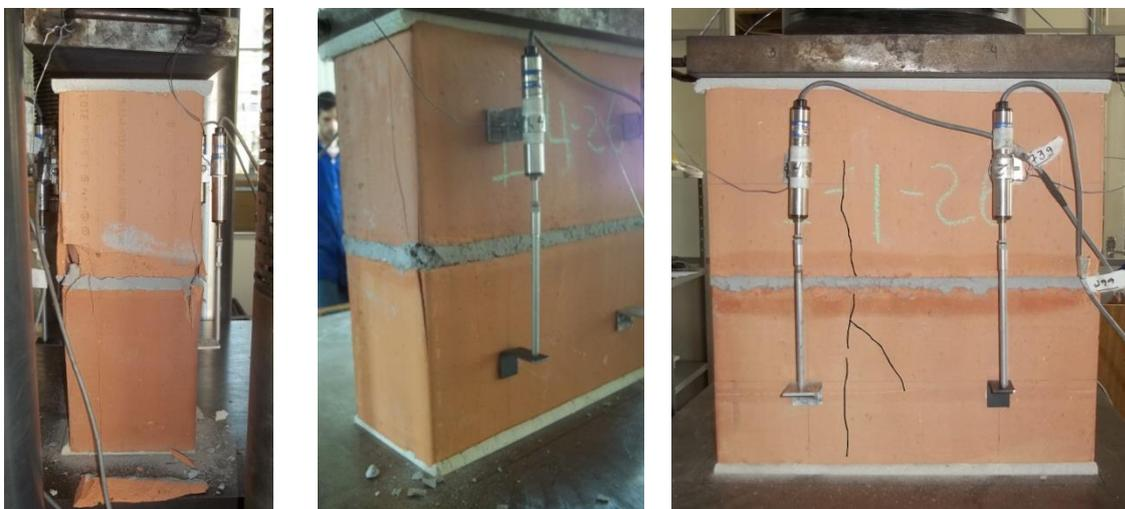
Figura 4.2 – Modo de ruptura dos prismas cerâmicos de dois blocos da série Ce (não grauteados)
