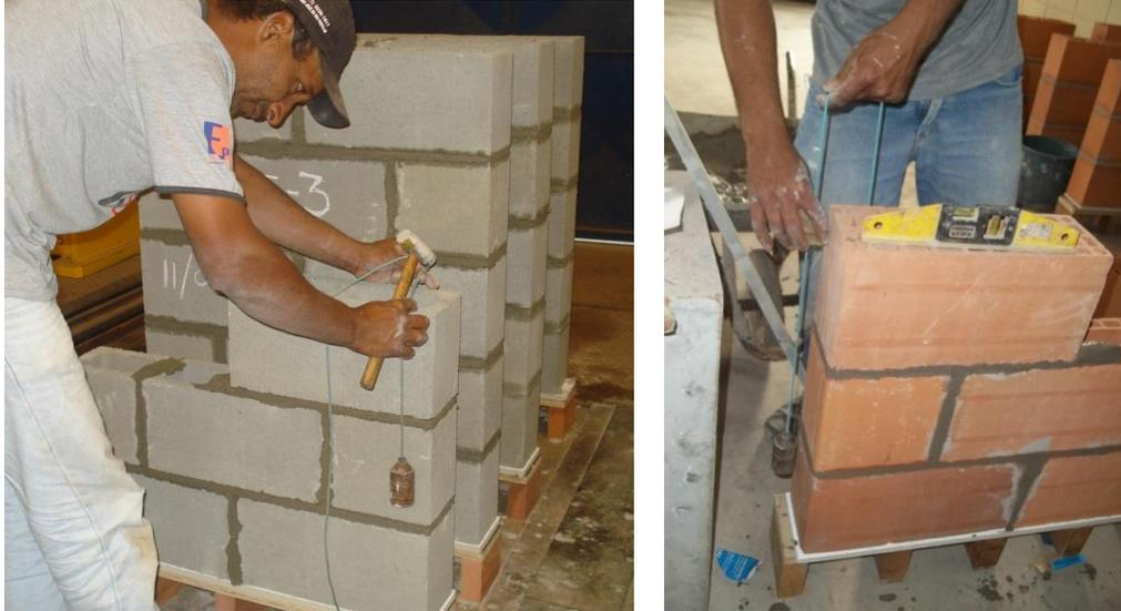
Figura 3.43 – Cuidados e verificações na execução das pequenas paredes
