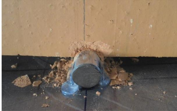
Figura 3.17 – Esmagamento dos blocos cerâmicos pelo cilindro
