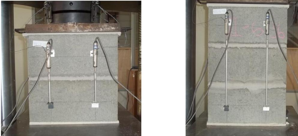
Figura 3.48 – Esquema de ensaio da resistência à compressão dos prismas de blocos e de concreto
