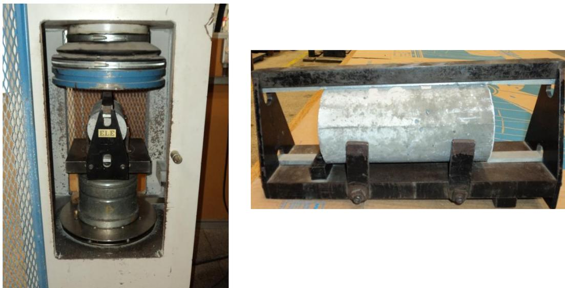
Figura 5.19 – Ensaio de compressão diametral do graute
