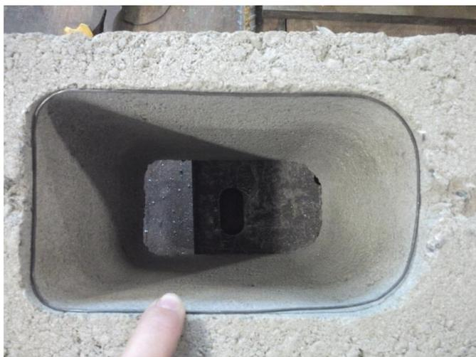
Figura 6.1 – Arame flexível ao longo do perímetro do furo do bloco de concreto
