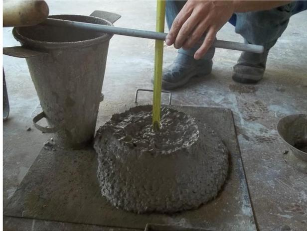
Figura 3.28 – Ensaio de consistência do graute
