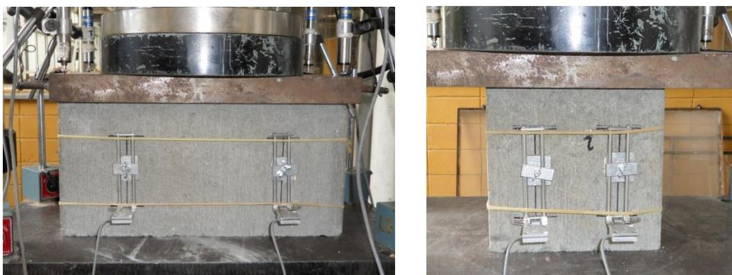
Figura 3.10 – Instrumentação utilizada no bloco inteiro e no meio bloco de concreto
