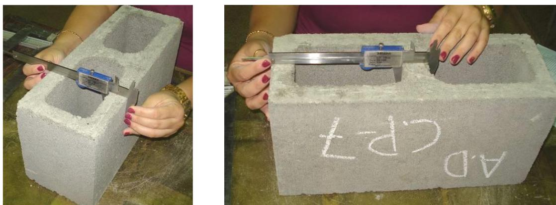
Figura 3.5 – Medição da espessura das paredes longitudinais e transversais dos blocos de concreto
