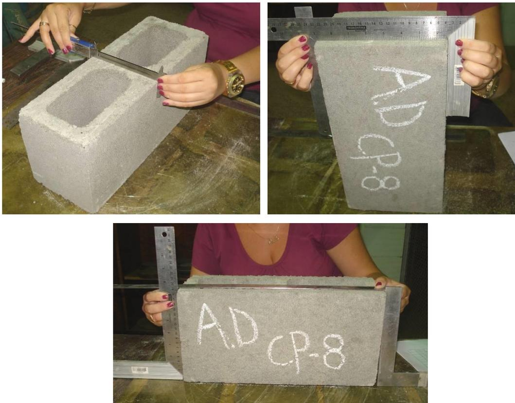
Figura 3.4 – Medição da largura, altura e comprimento dos blocos de concreto
