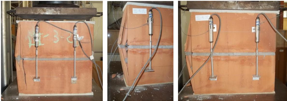
Figura 4.4 – Modo de ruptura dos prismas cerâmicos de dois blocos da série CeG30 (graute G30)
